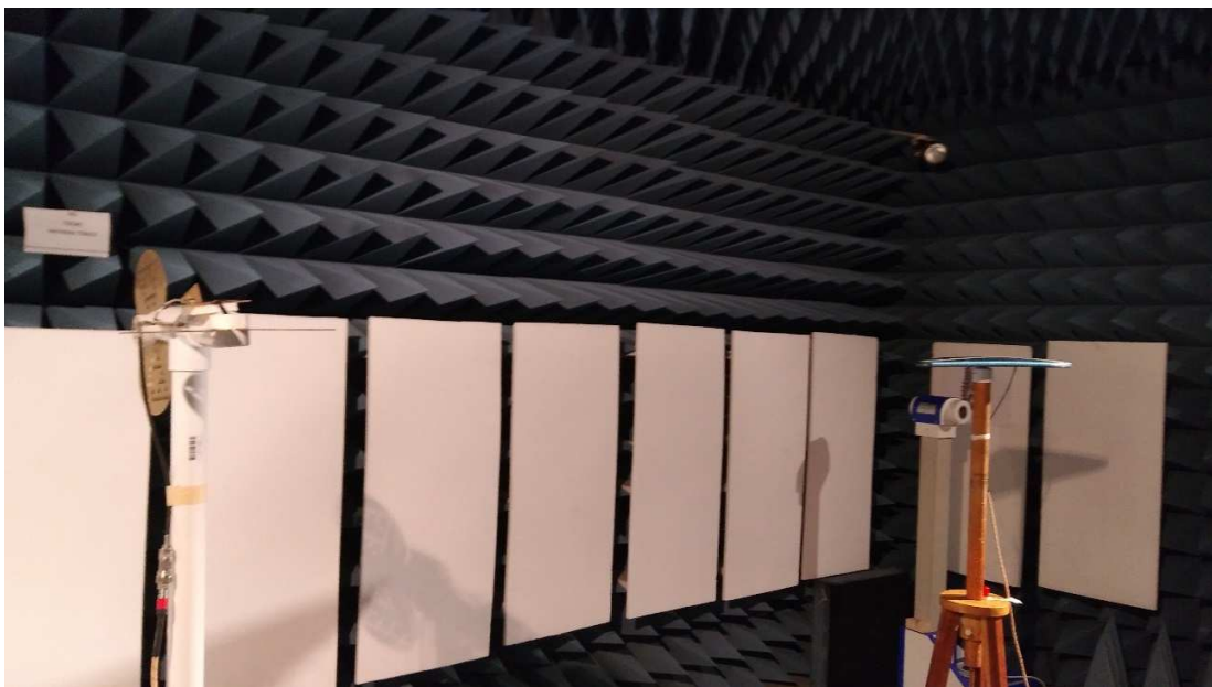
Fig. 5.7 Configuración para medición del patrón de radiación de la antenna dipolo de brazos elípticos con técnica fractal. [1]
