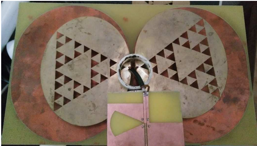
Fig. 5.11 Comparación de la antena dipolo de brazos elípticos con técnica fractal en comparación con la antena original.
