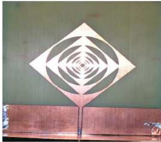
Fig. 2.20 Antena monopolo cuadrado de ultra ancho de banda [26].
