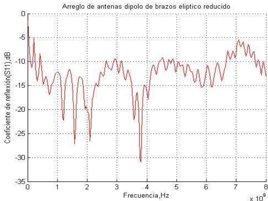
Fig. 5.6 Coeficiente de reflexión (Parámetro S_{11} ) medido en el VNA Agilent N5244A del arreglo de antenas dipolo de brazos elíptico reducido con técnica fractal.
