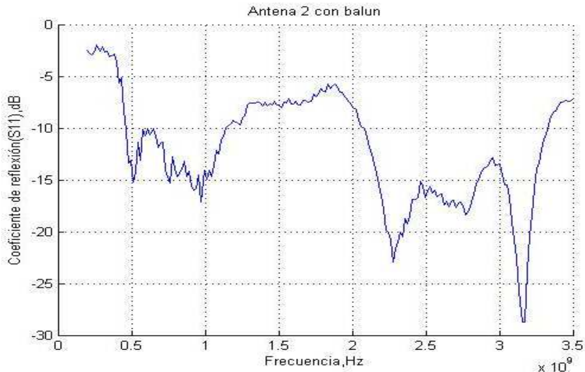
Fig. 5.2 Coeficiente de reflexión de la antena 2 con balun medido y graficado en MATLAB.
