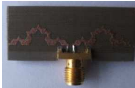
Fig. 2.22 Antena fractal para sistemas de comunicaciones en la banda de 2.4 GHz [28].
